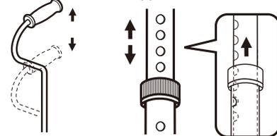
インサートロックピンを差し込みます      スライドロックナットを締めます
