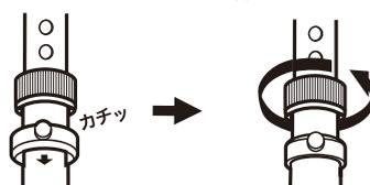
使用中にインサートロックピンが抜けないよう、インサートロックピンの径が硬く、強く押さないと固定できないようにしてあります。
